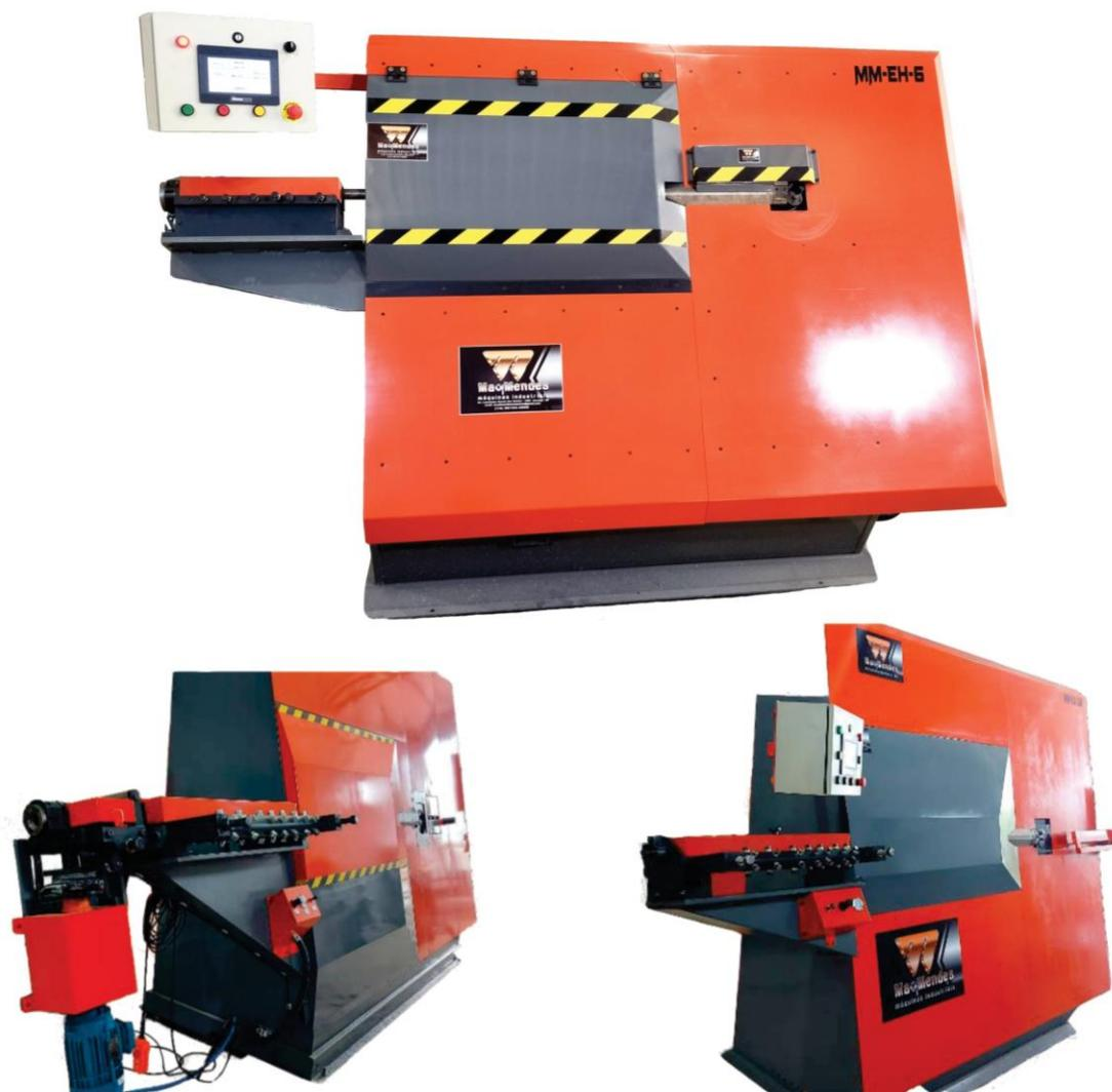
Equipamentos automáticos voltados para conformação de estribos e endireitamento de barras para a construção civil, garantindo qualidade e agilizando tempo nas obras.
